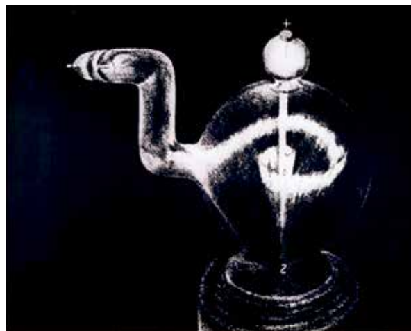
Figur 2. Nordlyskrukken er starten på generering av kunstignordlys i laboratoriet. Illustrasjonen er brukt i flere av hans tidlige avhandlinger.
