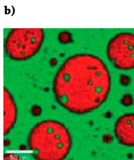
Figur 5. a) Raman-mikroskop, prinsipp. b) Raman-mikroskopbilde av polymerblanding. Fargekoder: raudt: polystyrén (PS); grønt: polymetylmetakrylat (PMMA). Fargene er kodar, ikkje reelle. Feltet dekker 50 \mu \times 50 \mu . (Etter WITec, Ulm)
